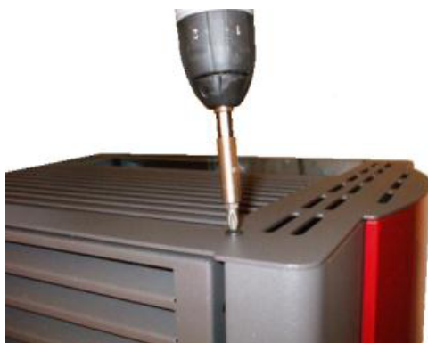
Fig. 13 - Rimozione viti superiori
