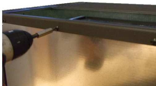
Fig. 14 - Levée les vis derrière
