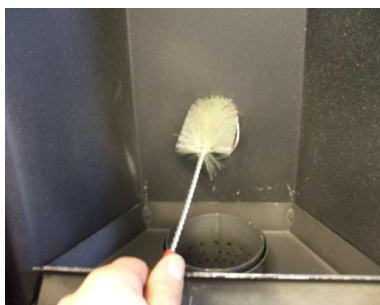
Fig. 34 - Nettoyage avec nettoie-pipes
