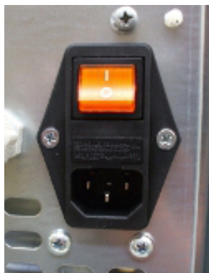
Fig. 24 - Presa elettrica con interruttore generale
