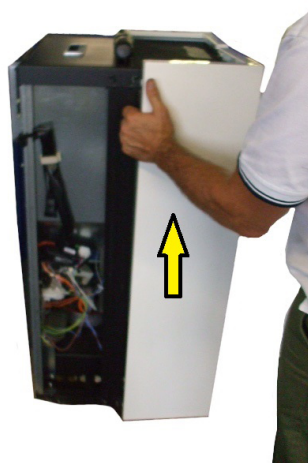
Fig. 21 - Détacher le côté
