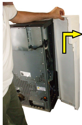
Fig. 20 - Détacher le côté
