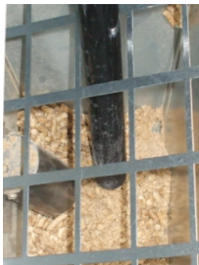
Fig. 36 - Pulizia serbatoio e coclea
