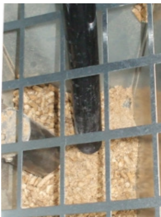
Fig. 43 - Limpeza do reservatório e da rosca sem fim
