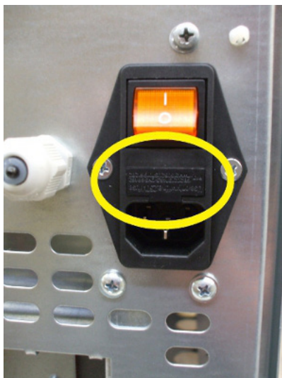
Fig. 58 - Deurtje met te verwijderen zekeringen
