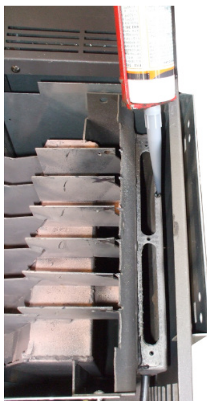
Fig. 54 - Application de la silicon
