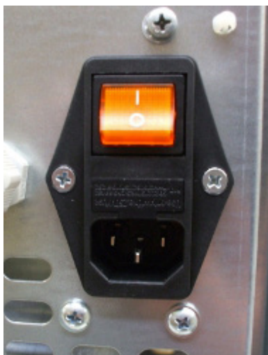
Fig. 31 - Prise électrique avec interrupteur général
