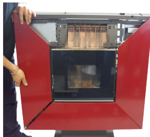
Fig. 25 - Πλαϊνή τοποθέτηση πάνελ
