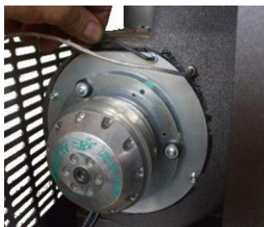
Fig. 47 - Limpeza do aspirador de fumos: fase 1
