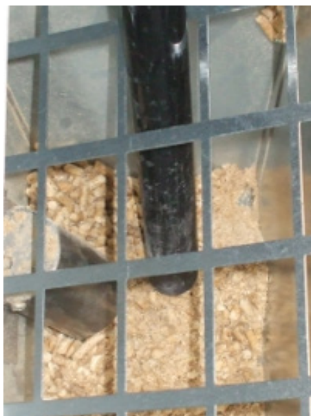
Fig. 45 - Pulizia serbatoio e coclea
