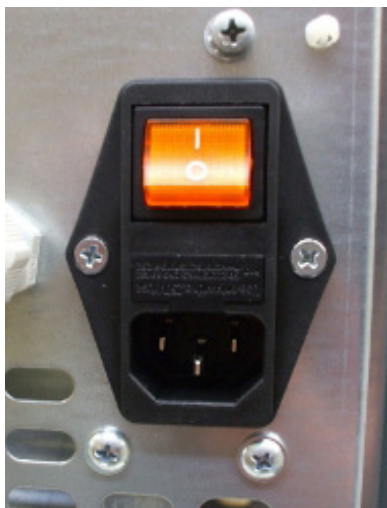
Fig. 33 - Presa elettrica con interruttore generale
