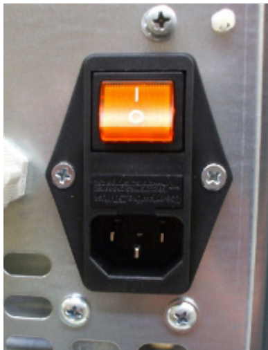
Fig. 33 - Toma de corriente con interruptor general
