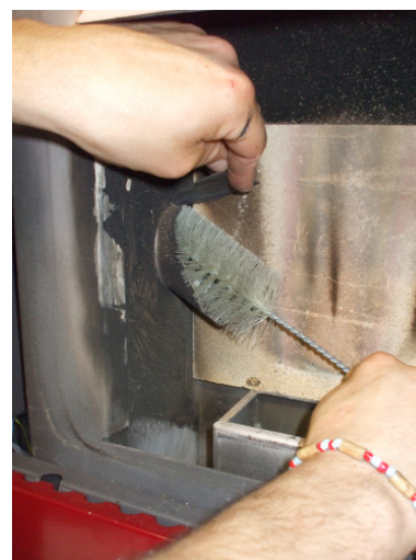
Fig. 42 - Nettoyage avec nettoie-pipes
