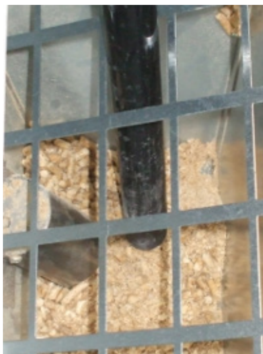
Fig. 43 - Nettoyage réservoir et vis sans fin
