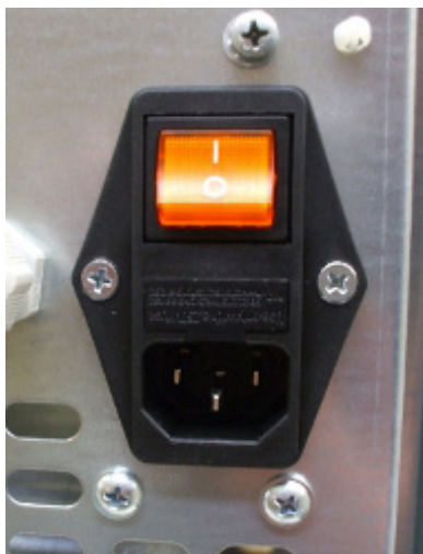
Fig. 33 - Elektrisch stopcontact met hoofdschakelaar
