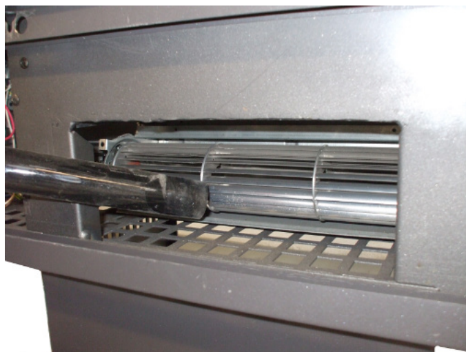
Fig. 52 - Limpieza ventilador ambiente
