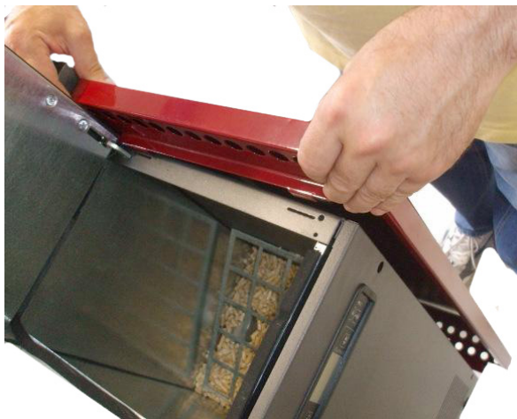
Fig. 31 - Plaatsing van de panelen
