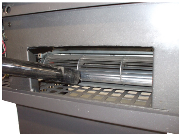
Fig. 50 - Nettoyage de le ventilateur ambiant
