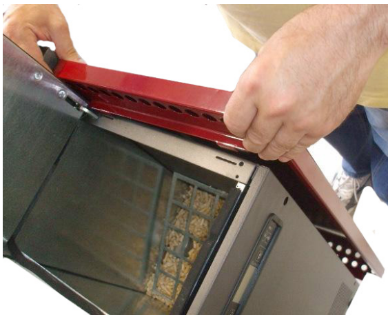
Fig. 31 - Inserimento dei pannelli
