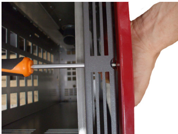
Fig. 29 - Fijación panel superior en metal o piedra
