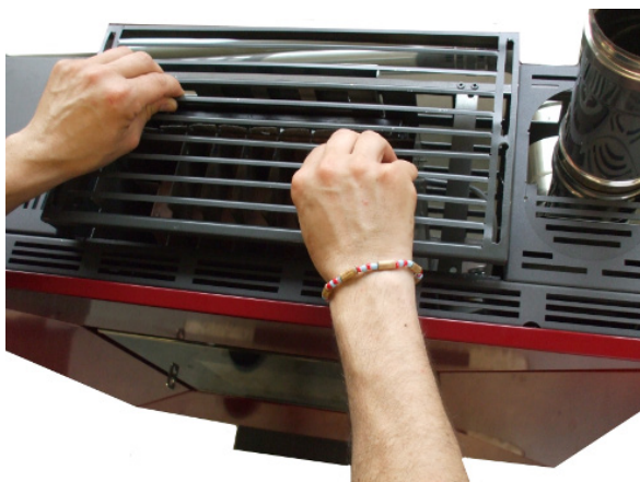
Fig. 53 - Rimozione griglia superiore
