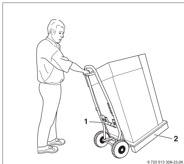
Afb. 7 CV-ketel aan het transportwagentje bevestigen
